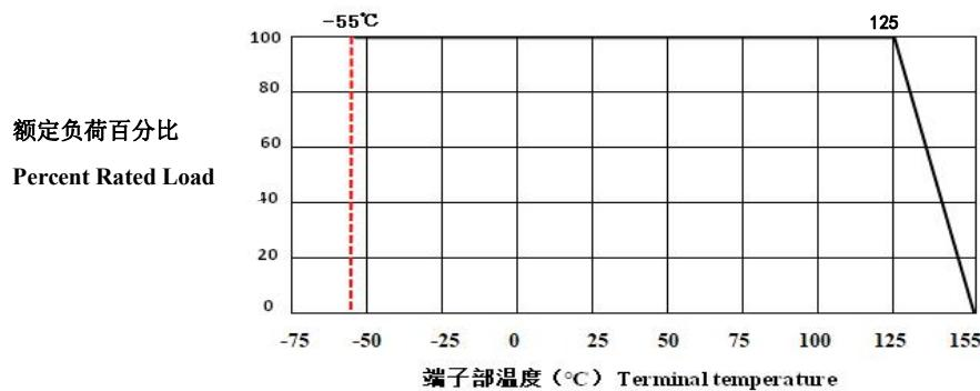
注 2：超过上述额定端子部温度使用时，请根据上述功率降额曲线减少额定功率后使用。
